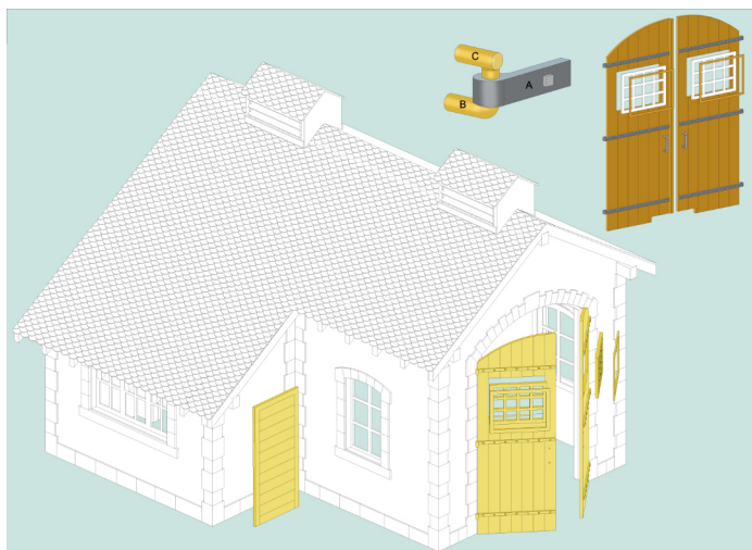
A La barre B Le gond C La tige horizontale qui empêche les portes de sortir de leurs gonds
